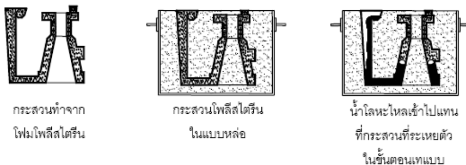
รูปที่ 2-31 การหล่อโดยใช้แบบหล่อโฟมหาย
