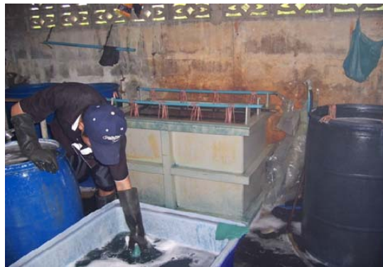
รูปที่ 2-38 การกำจัดสนิมด้วยกรด
